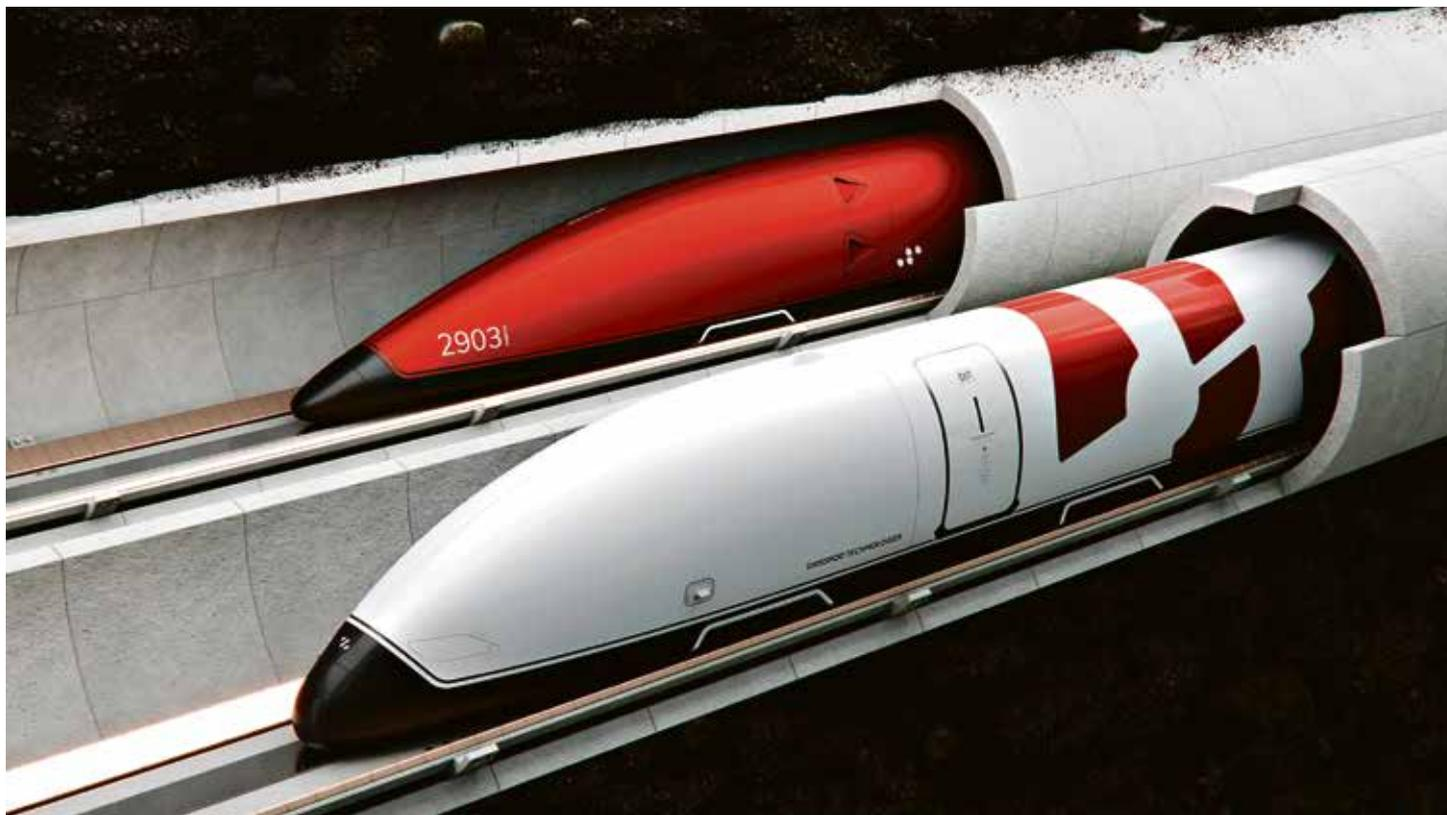
Swisspod Technologies, un spin-off de l'EPFL, veut développer des petits véhicules ultra-rapides, qui circuleraient en lévitation dans des tubes souterrains et surélevés vidés de tout air. La start-up doit réaliser un premier test sous vide début 2022. (DR)
