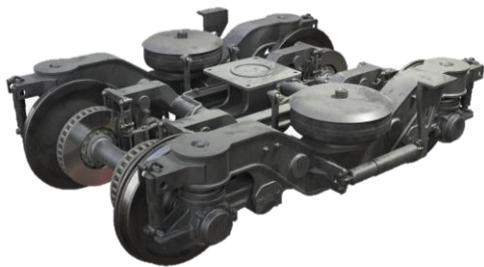
*Le bogie est l'élément de liaison entre le châssis du train et la voie. Composé de deux essieux, il peut intégrer les moteurs de traction et le système de freinage. Il assure aussi la suspension de la caisse.*
