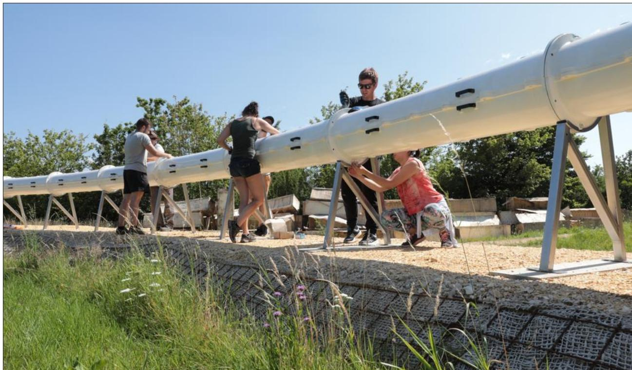
**L'EPFL a inauguré ce vendredi 23 juillet un banc d'essai bardé de capteurs (le premier d'Europe) pour développer les recherches sur l'Hyperloop, ce système de capsules ressemblant à une petite rame de train électrique dans un tube sous vide, pour éviter les frottements de l'air... Photo EPFL**
