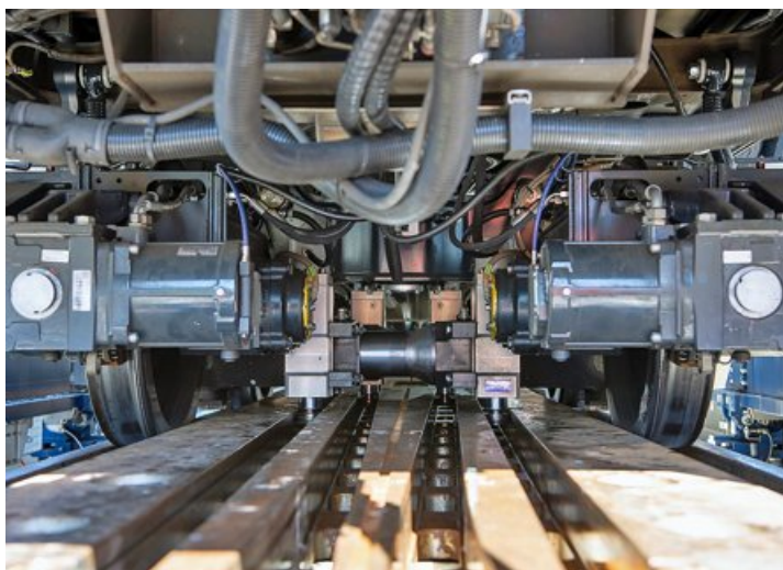
Les bogies à écartement variable permettent aux trains de passer de la voie métrique du MOB à la voie normale du BLS.
