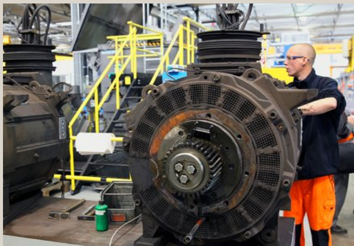
Démontage d'un moteur de locomotive RE460 à Yverdon. O.ALLENSPACH
