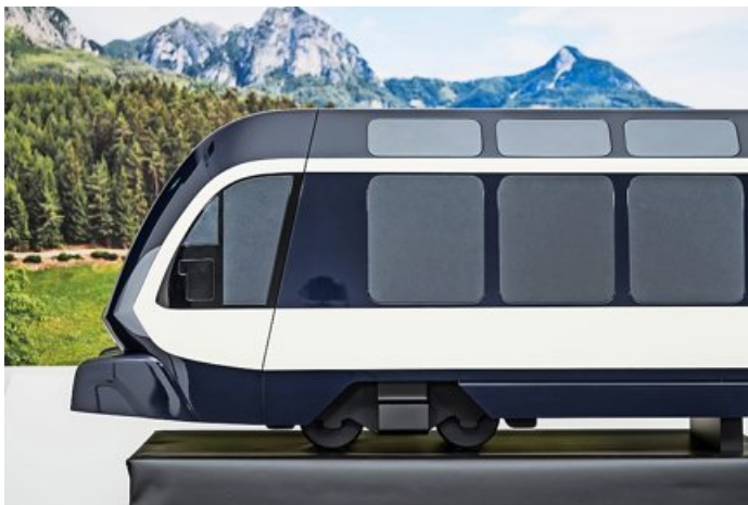
Les rames seront dotées de bogies à écartement variable permettant le passage des voies du MOB au réseau BLS. DR
