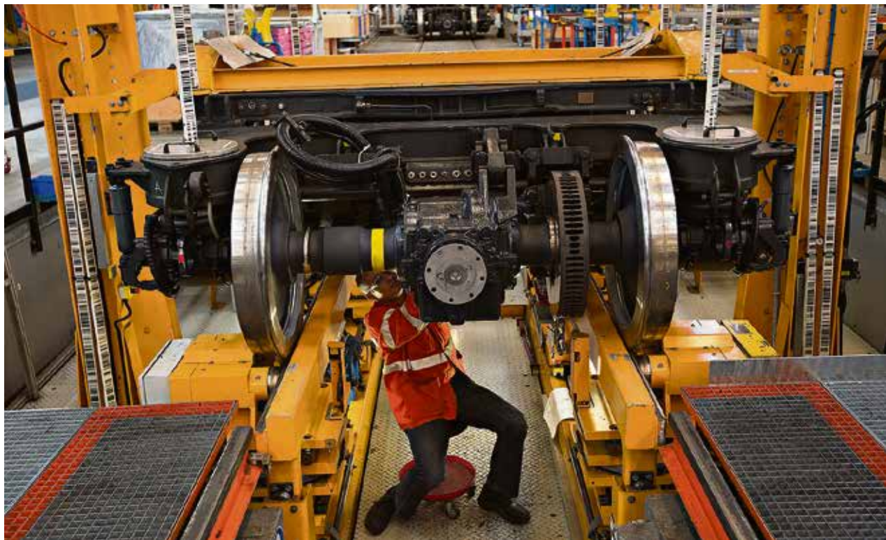
Un atelier d'entretien des bogies, ces éléments composés de deux essieux sur lesquels repose le châssis des wagons. (KEYSTONE/SALVATORE DI NOLFI)
