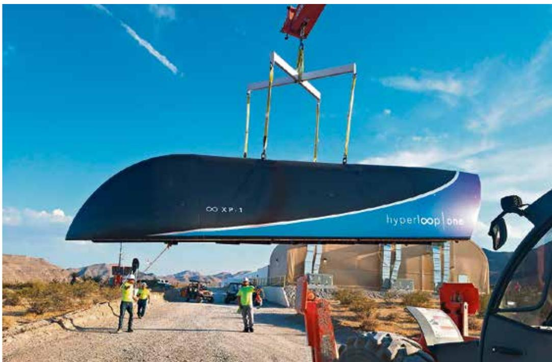
Le prototype de capsule Hyperloop, en aluminium et fibre de carbone, mise sur la légèreté. (WEBER SHANDWICK/AFP)
