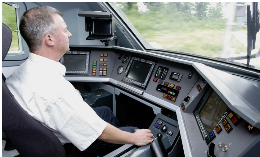
↑ Train pendulaire Intercity – Cabine de conduite équipée de la technologie GSM-R (ETCS II).
