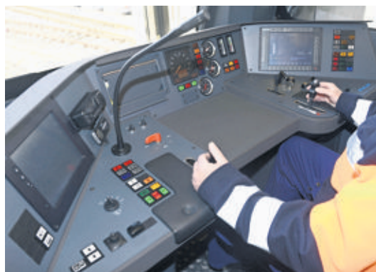
Au poste de conduite des nouvelles rames, un joystick a remplacé le volant combinateur.
