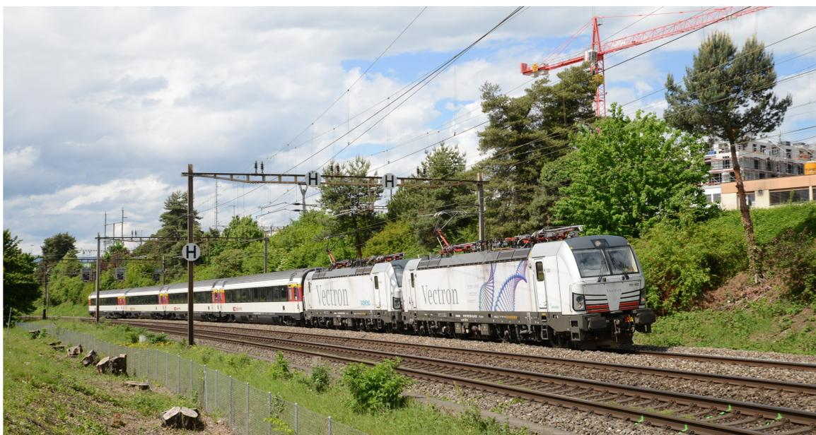
Figure 1 : Train spécial de matériel vide roulant entre Berne et Sion via Lausanne-Triage, ici à la hauteur du gymnase Provence sur la voie 300. Ces deux locomotives BR 193 de type Vectron, destinées au trafic BLS Cargo, seront testées entre Sion et Sierre.
