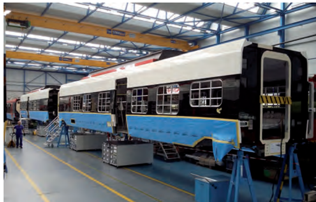
Caisses des nouvelles rames Giruno en cours de montage ; les baies des fenêtres sont pourvues de châssis provisoires assurant la rigidité en attendant le montage des vitrages (Stadler Rail)
