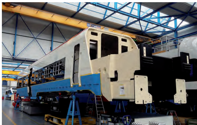
Voiture de tête avec les structures d'absorption de chocs ; des protections temporaires bleues sont installées lors des travaux de montage (Stadler Rail)
