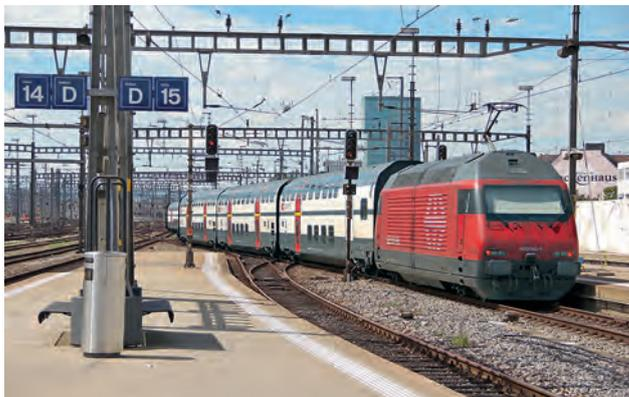
Train InterCity au départ de Zurich, gare principale. La Re 460 082 en queue pousse des voitures à deux étages du type IC 2000 avec une charge à l'essieu de 21 tonnes, respectivement 15 tonnes (E. Suter)
