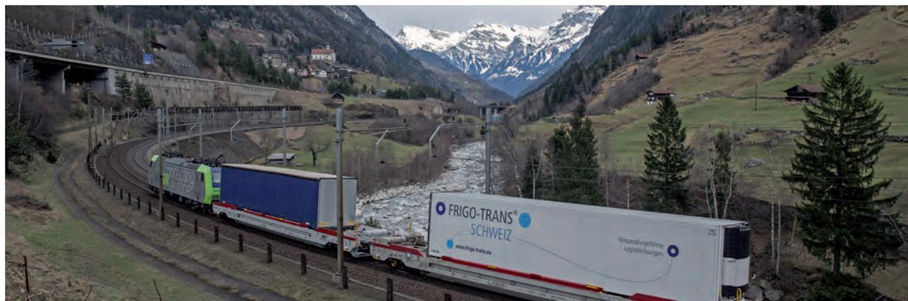
Wagon CargoBeamer pour le transport des semi-remorques d'une hauteur de 4 mètres en essai sur la ligne du St-Gothard (© CargoBeamer AG)
