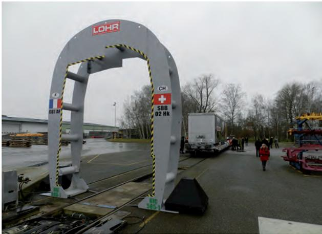
Gabarit des tunnels sur l'axe actuel du Gothard pour semi-remorques standards de quatre mètres de hauteur (© PHC)
