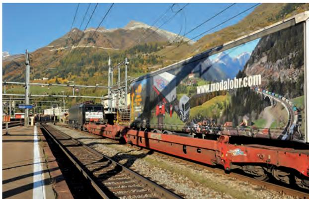
Wagon Lohr pour le transport des semi-remorques d'une hauteur de quatre mètres en essai sur la ligne du Saint-Gothard (© SME)
