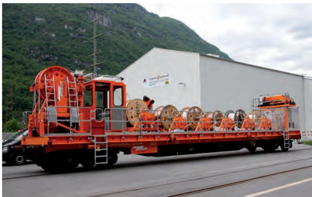
Wagon spécial pour la pose de la ligne de contact (© Transtec Gotthard)
