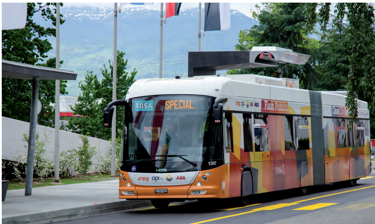
Grâce à la recharge flash, ABB est en mesure de proposer une nouvelle génération de bus électriques pour le transport public urbain de masse s'affranchissant des lignes de contact (© ABB)
