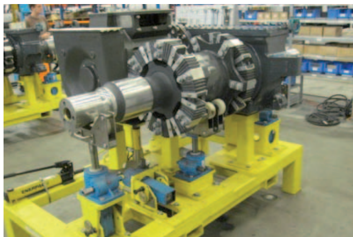
Support de montage/démontage du réducteur.
