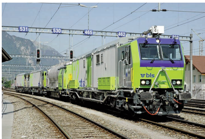
Le train d'extinction du BLS pour le tunnel du Lötschberg. (sp/bls)
